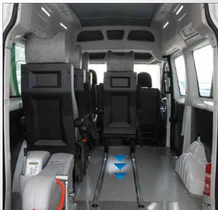
**Flex Floor** Pavimento con sedili singoli scorrevoli e sganciabili su guida. Queste caratteristiche consentono di modulare la configurazione dei posti viaggio in funzione delle esigenze di trasporto.
