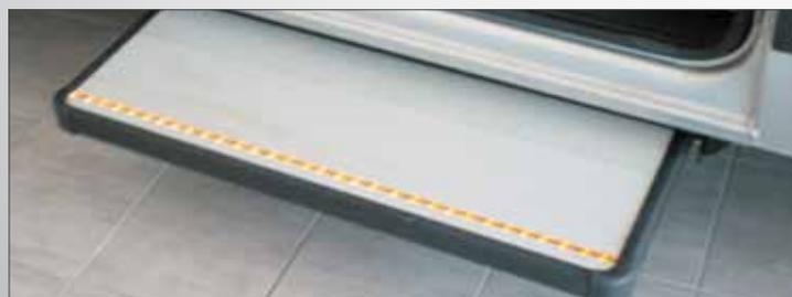
**Gradino laterale** Può essere installato sulla porta laterale e facilita l'entrata e l'uscita dal veicolo. Con pavimento antiscivolo e LED di visualizzazione notturna.
