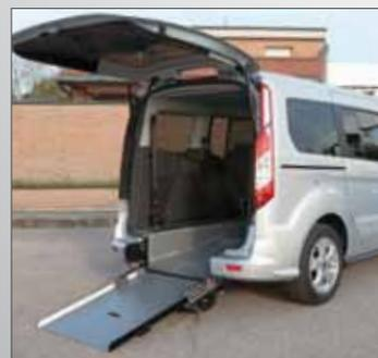
**Accessibilità** Con la rampa completamente aperta e abbassata Ford Tourneo Connect diventa completamente accessibile per le persone in carrozzina, offrendo un'ampia abitabilità nell'area di stazionamento della carrozzina.
