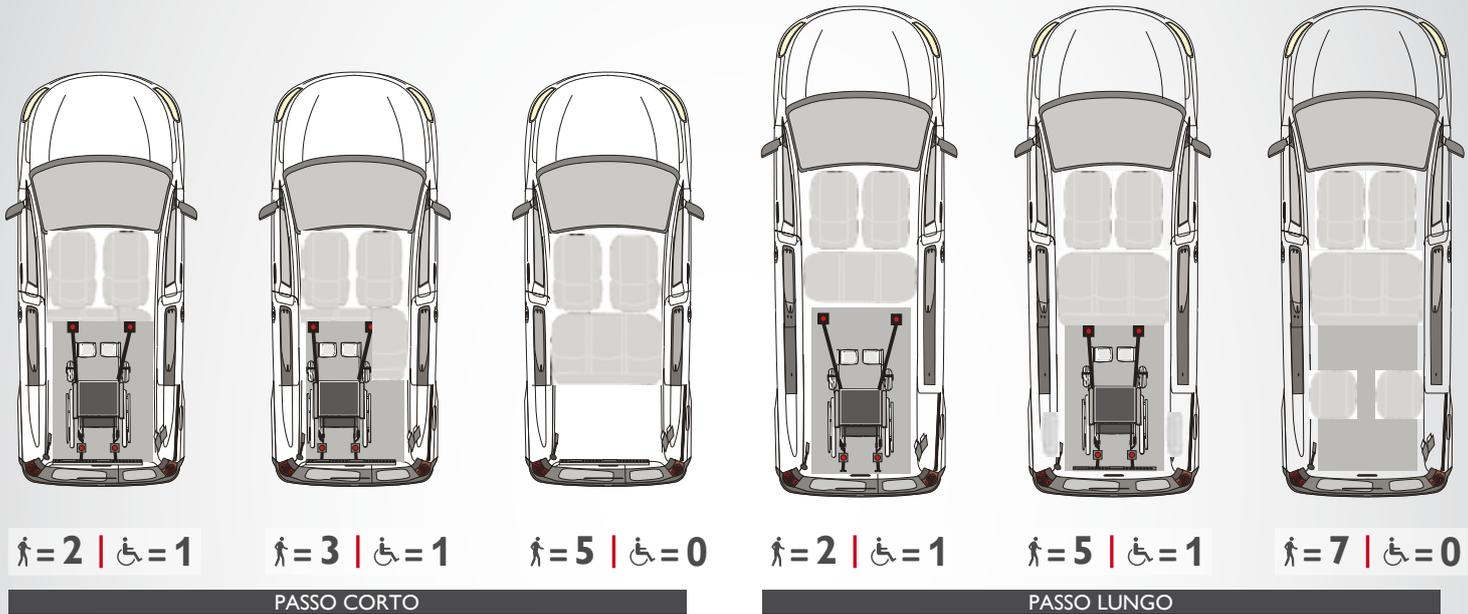
Altezza punto d'ingresso 1450 mm - Altezza interna utile 1380 mm - Area Stazionamento Carrozina 795x1300 mm\*
