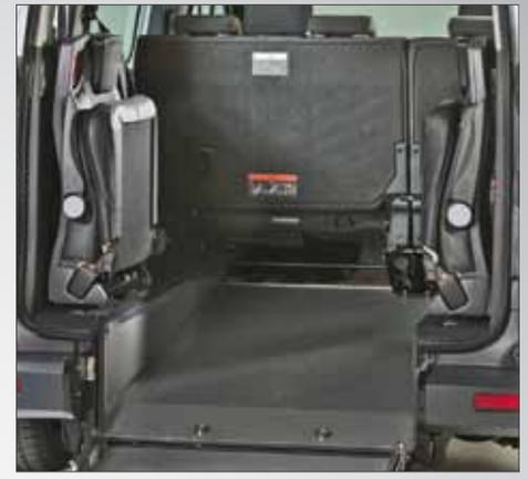
**Flex Ramp** permette alla rampa di essere ribaltata verso l'interno del veicolo e di creare un piano d'appoggio per lo stivaggio di bagagli. Le panchette originali ribaltabili consentono una grande versatilità nella configurazione dei posti. Inoltre nella versione a passo lungo, i sedili girevoli e richiudibili in optional consentono, in caso di non utilizzo della rampa, di trasportare fino a 7 passeggeri.
